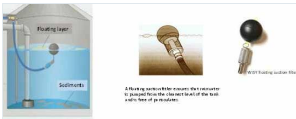
8. ábra: Lebegő eszköz, amely szivattyúval szállítja a vizet a különböző felhasználási pontokhoz.
