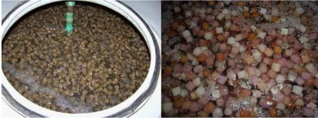
13. ábra: Szellőztetett mozgóágyas biofilmreaktor (MBBR) (balra) és habkockák mint hordozó közeg (Fotó: E. Nolde).
