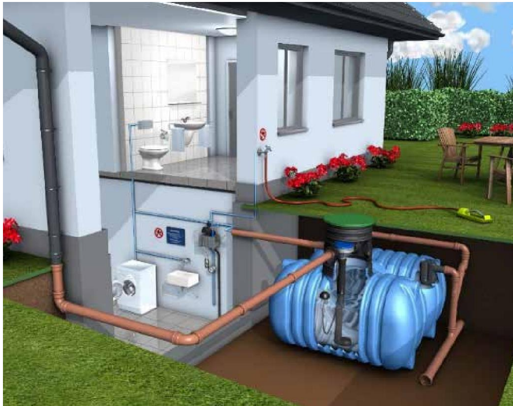
6. ábra: Egy földalatti esővízgyűjtő ciszterna vázlata a beltéri és kültéri víz újrafelhasználásához (fbr).
