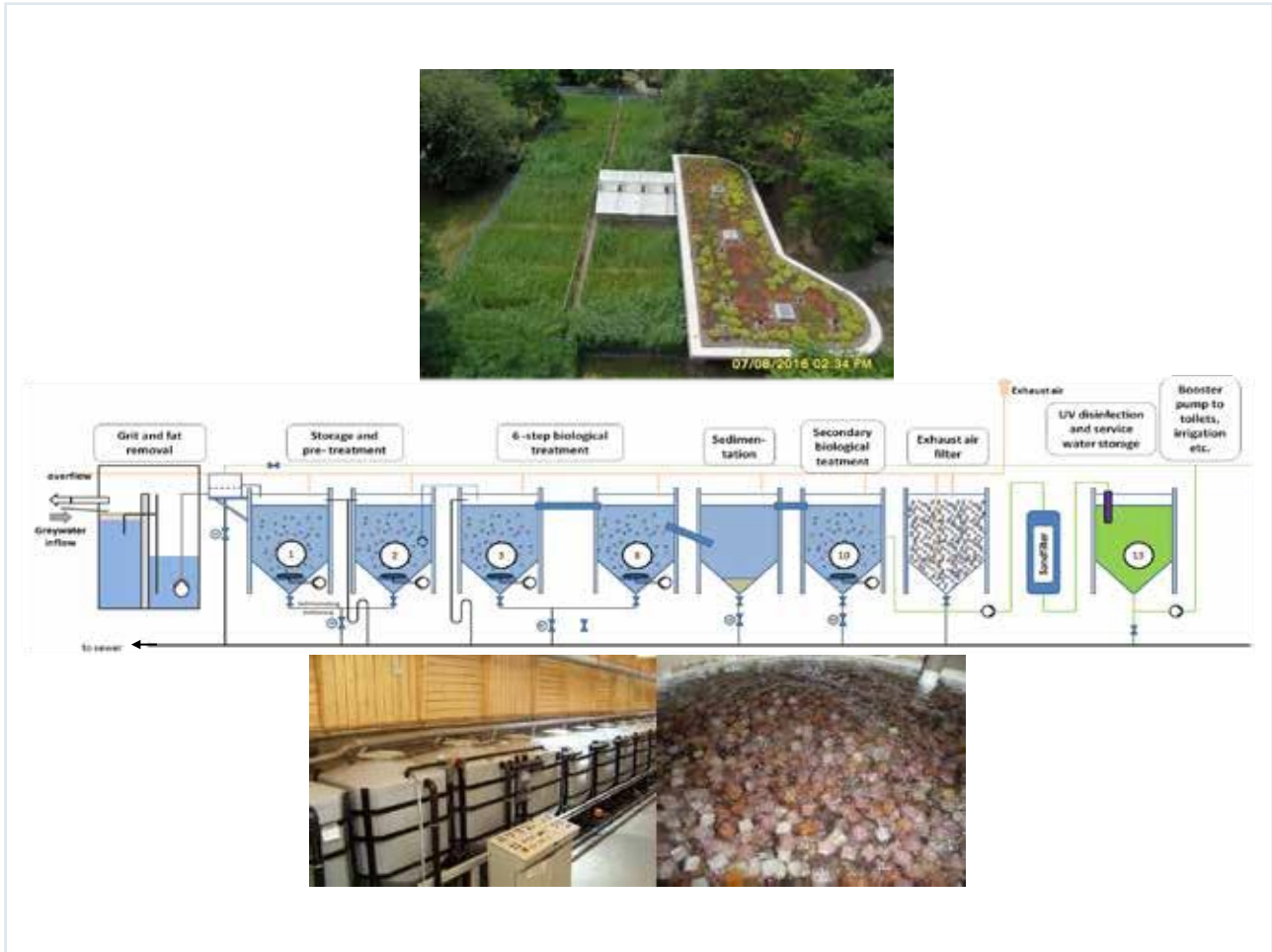
21. ábra: A szürkevíz-újrahasznosító rendszert tartalmazó úgynevezett „vízház” (fent) és a különböző MBBR kezelési szakaszok sematikus ábrája. A levegőztetett MBBR hordozóanyaggal (jobbra lent).
